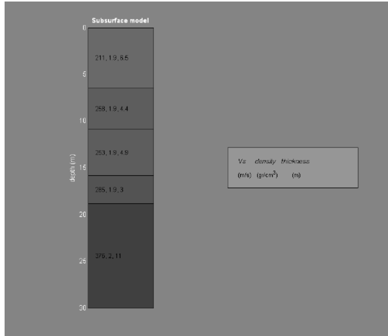
Fig. 4. Colonnina sismo-stratigrafica di massima del sito. Per ciascun strato indicate V_s , densità (stimate) e spessori.
