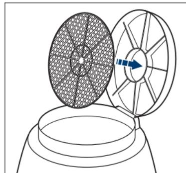
La rete viene applicata a pressione sulla parte interna del coperchio: far coincidere la parte centrale della rete con quella del coperchio ed esercitare una leggera pressione; i ganci metallici creano una interferenza che fissa la rete al coperchio. L'applicazione della rete sul coperchio non crea alcun problema all'apertura/chiusura del coperchio.
