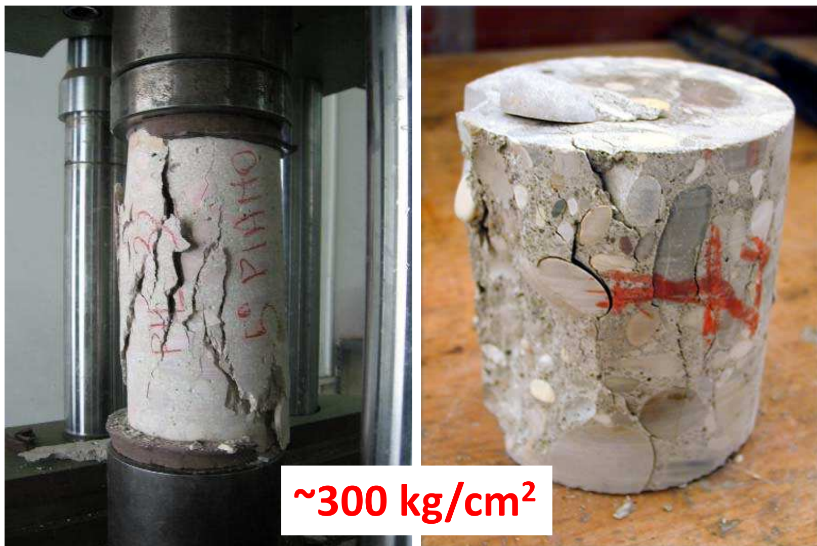
Esempi di rottura di carote di calcestruzzo con resistenza «normale» per uso strutturale
