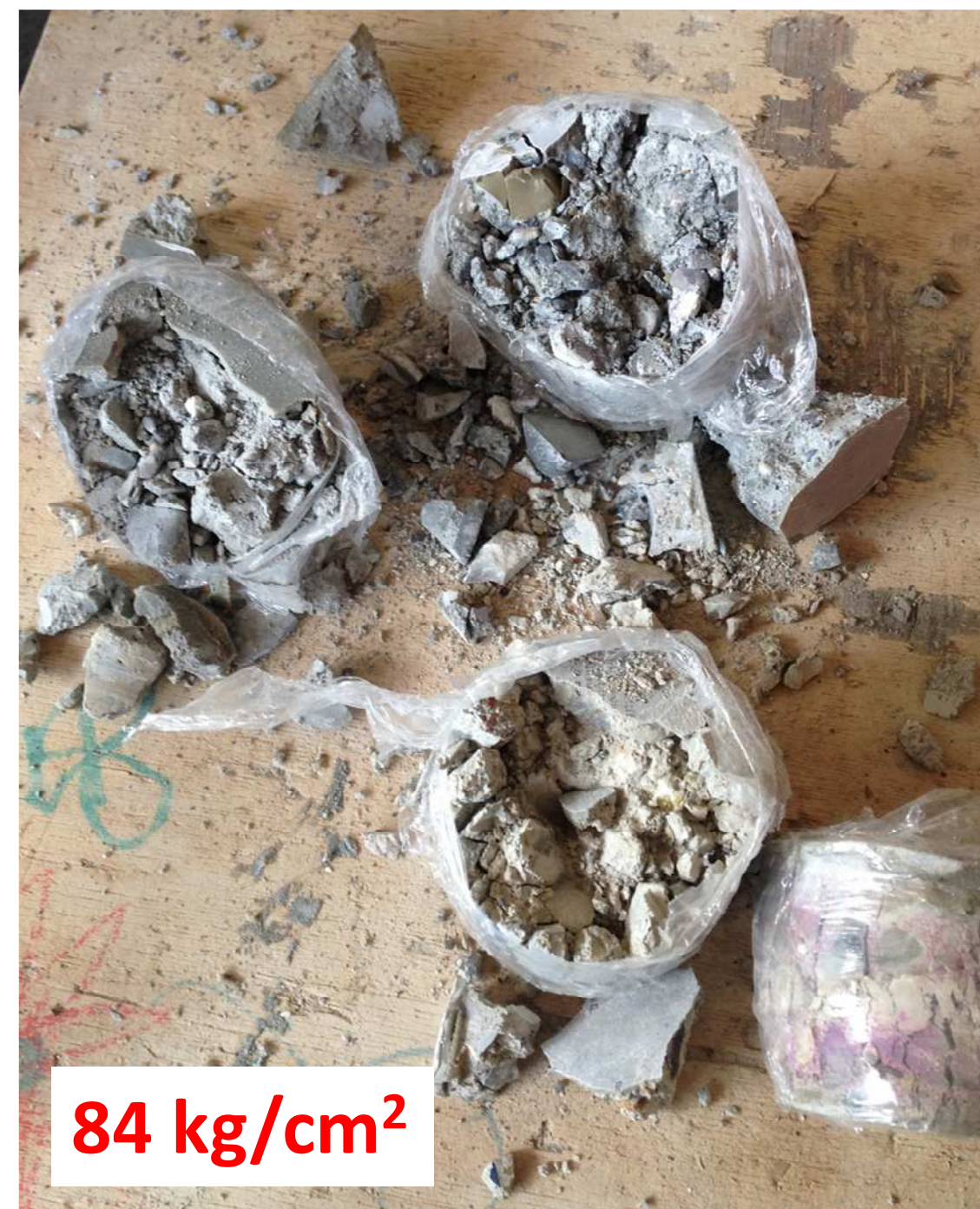
Carote estratte dalle strutture della Scuola Fucini dopo la prova di compressione
